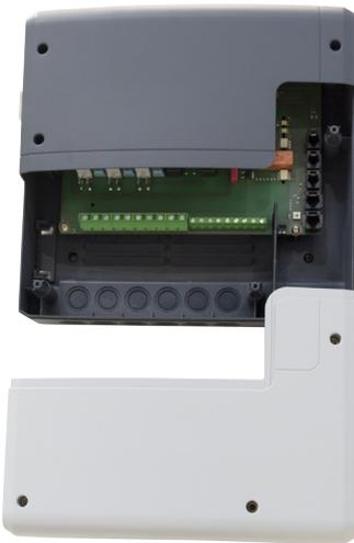
Leistungsteil, Unterteil der Frontabdeckung geöffnet
